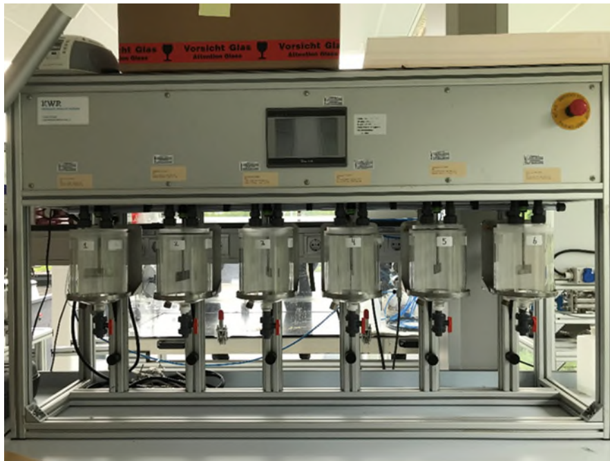
Figuur 5-5 Testapparaat voor bekerteksten in de werkplaats van KWR.
