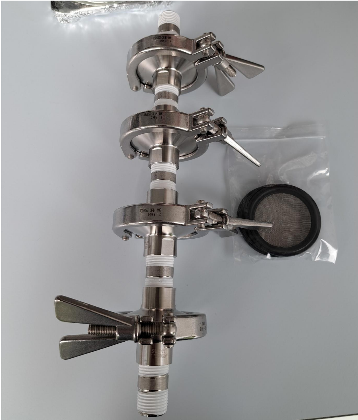
Afbeelding 1. Een filtercascade met vier filters, gerangschikt van boven naar beneden. De twee primaire filters (100 \mu\text{m} en <20 \mu\text{m} ) vangen de zwevende deeltjes in het water, waaronder mogelijke microplastics. De twee secundaire filters (100 \mu\text{m} en <20 \mu\text{m} ) dienen als blanco controlefilters. Deze worden niet blootgesteld aan het watermonster, maar worden geanalyseerd om eventuele contaminatie door externe bronnen, zoals lucht, tijdens de monsternamen te kwantificeren. Deze contaminatie zou kunnen worden geïntroduceerd na de monsternamen. De secundaire filters fungeren als kwaliteitscontrole om onderscheid te maken tussen microplastics die daadwerkelijk in het water aanwezig zijn en microplastics die mogelijk tijdens de analyse zijn geïntroduceerd
